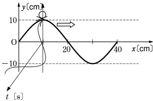
媒質 10 cm の点の人形は、 $t = 0$  では山の位置で、最初に下向きに変位する動きだとわかる。
