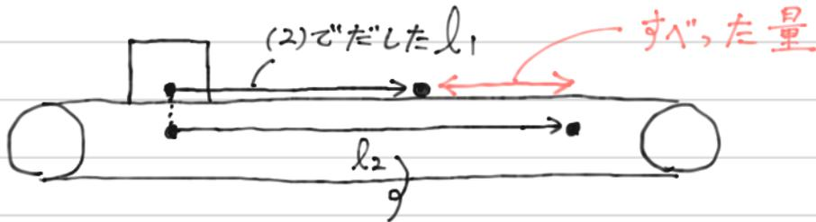
ベルトコンベアーは一定の速度  $v$  で  $t$  [s] 進む
