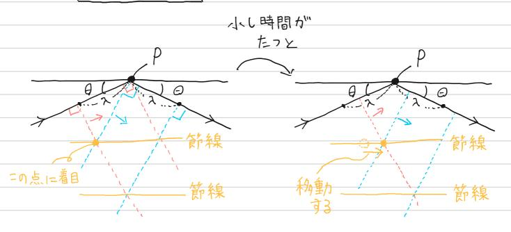
ニニで、入射波、反射波の周期T [s] だけ時間が経過したときの、●点の粉動量を Xとして113.
