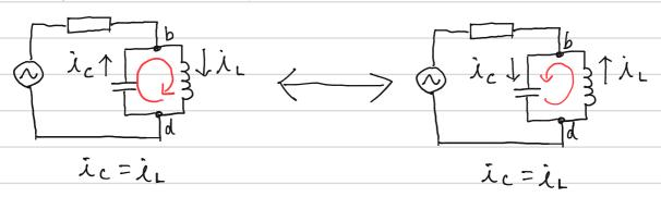
上記のようにLC振動回路のように電流が流れていて、 抵抗に電流が流れていない状態を共振と呼ぶ。
