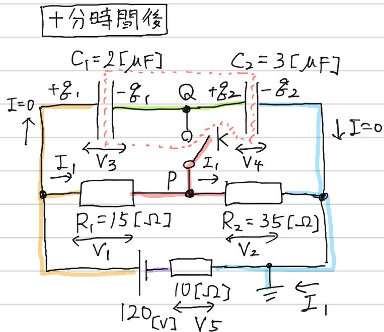
(1) 十分時間後、コンデンサーに電流は流れないので、3つの抵抗に流れる電流は全て同じになる。⇒  $I_1$  とおく。
